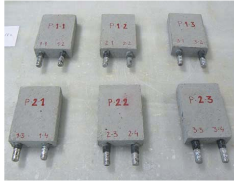
Figura 3 Probetas de mortero transcurridos 28 días de curado.
