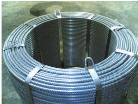
Figura 13 Alambón corrugado de Inoxfil en rollos trancanés.
