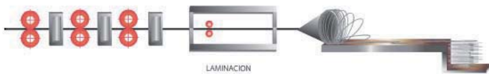
Figura 6 Esquema del proceso de laminación en caliente.
