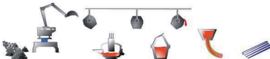
Figura 3 Esquema de fabricación de la acería.
