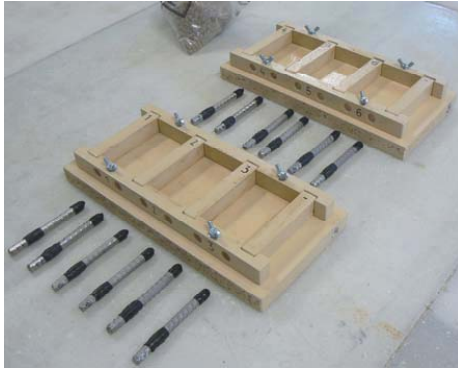
Figura 2 Barras de acero inoxidable preparadas para embeber en probetas de mortero.
