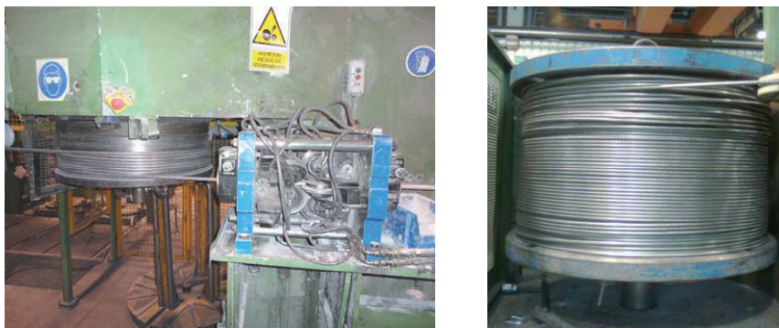
Figura 14 Cabezal corrugador (izda.) y bobinador (dcha.).
